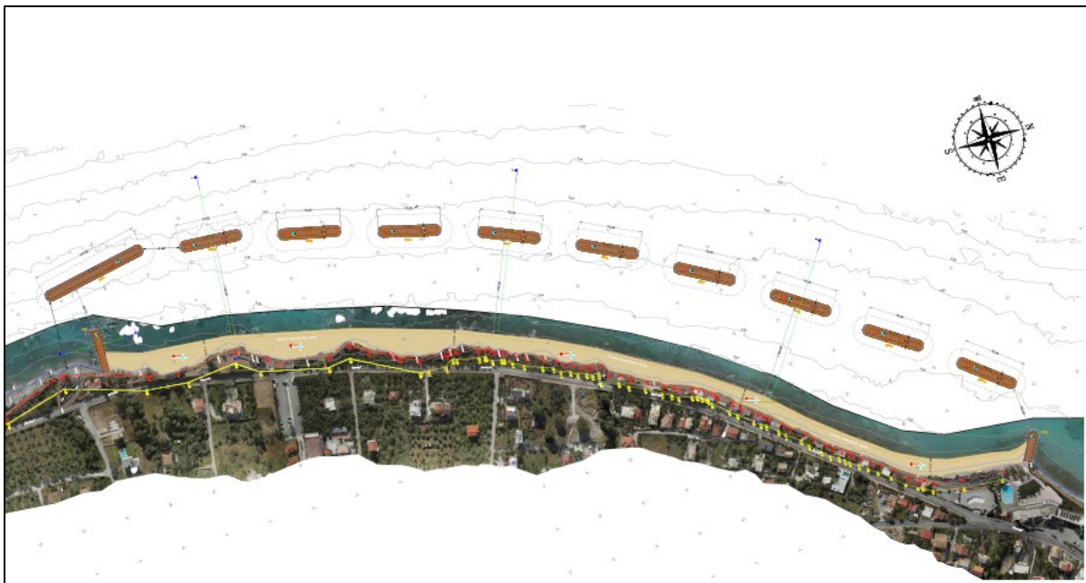
Εικόνα 1-6: Διάταξη προτεινόμενων παρεμβάσεων (πηγή: απόσπασμα σχεδίου ΜΠΕ-05)
