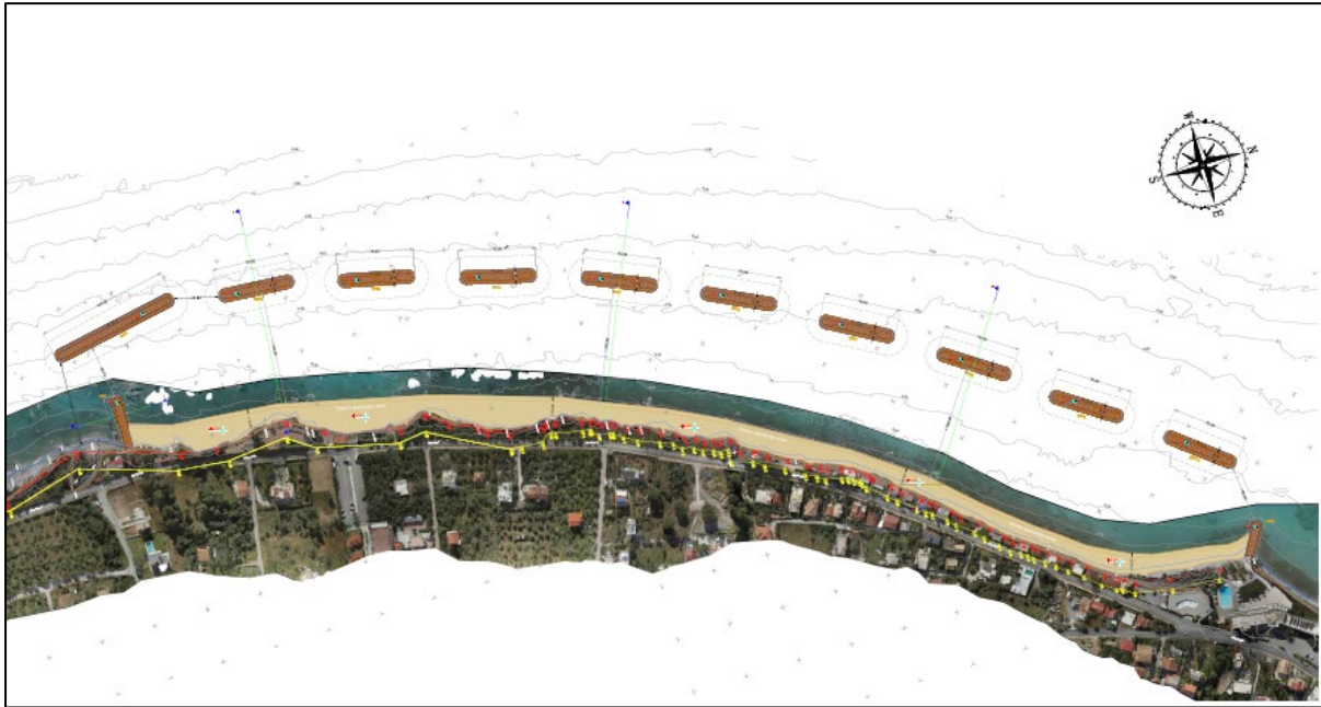
Εικόνα 3-6: Διάταξη προτεινόμενων παρεμβάσεων (πηγή: απόσπασμα σχεδίου ΜΠΕ-05)
