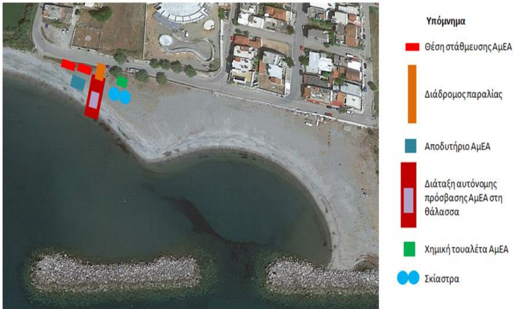
Εικόνα 8: Ενδεικτικό σκαρίφημα διάταξης μη μόνιμων κατασκευών στον Κορδία
