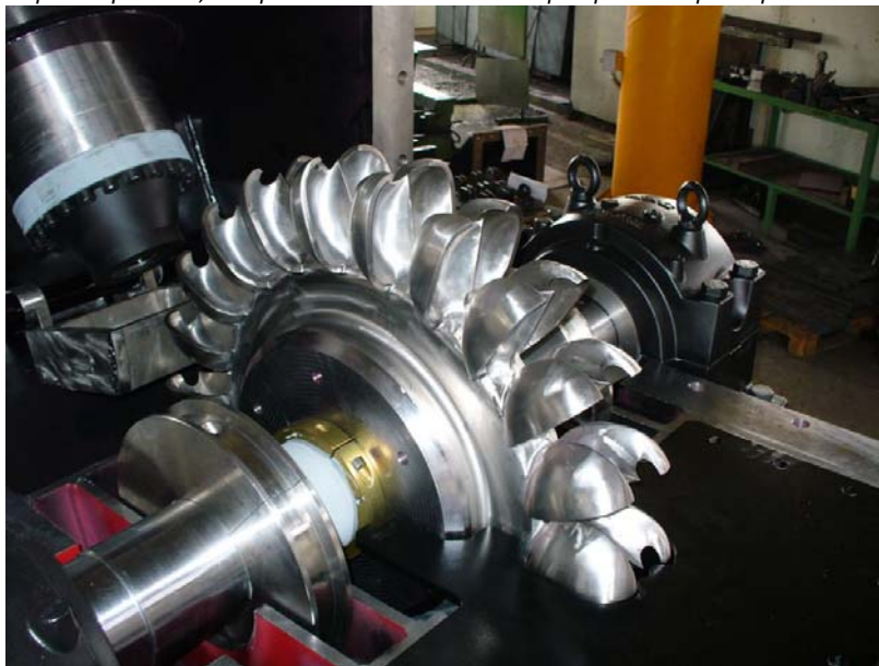
Εικόνα 7: Εσωτερικό στρόβιλου, διακρίνονται τα πιάτα όπου πέφτει με ένταση το νερό και κινεί τον στρόβιλο
